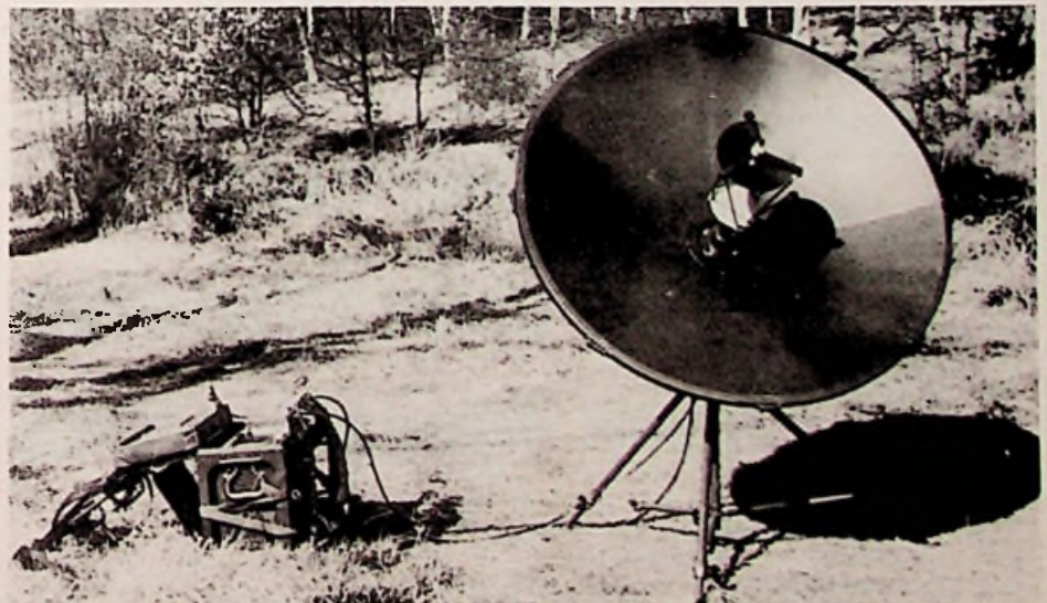
Het goedkope, lichtgewicht draagbare satellietstation „Compack“, zoals dat door Marconi zal worden gefabriceerd. Het kan eenvoudig worden gedragen door drie man en worden opgesteld en gebruikt „in het veld“. Een kleinere versie zal zelfs door één man kunnen worden gedragen!
